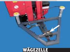
DMS-Wägezelle mit doppeltem Sicherheitskanal für eine optimale Kontrolle der Korblast.
